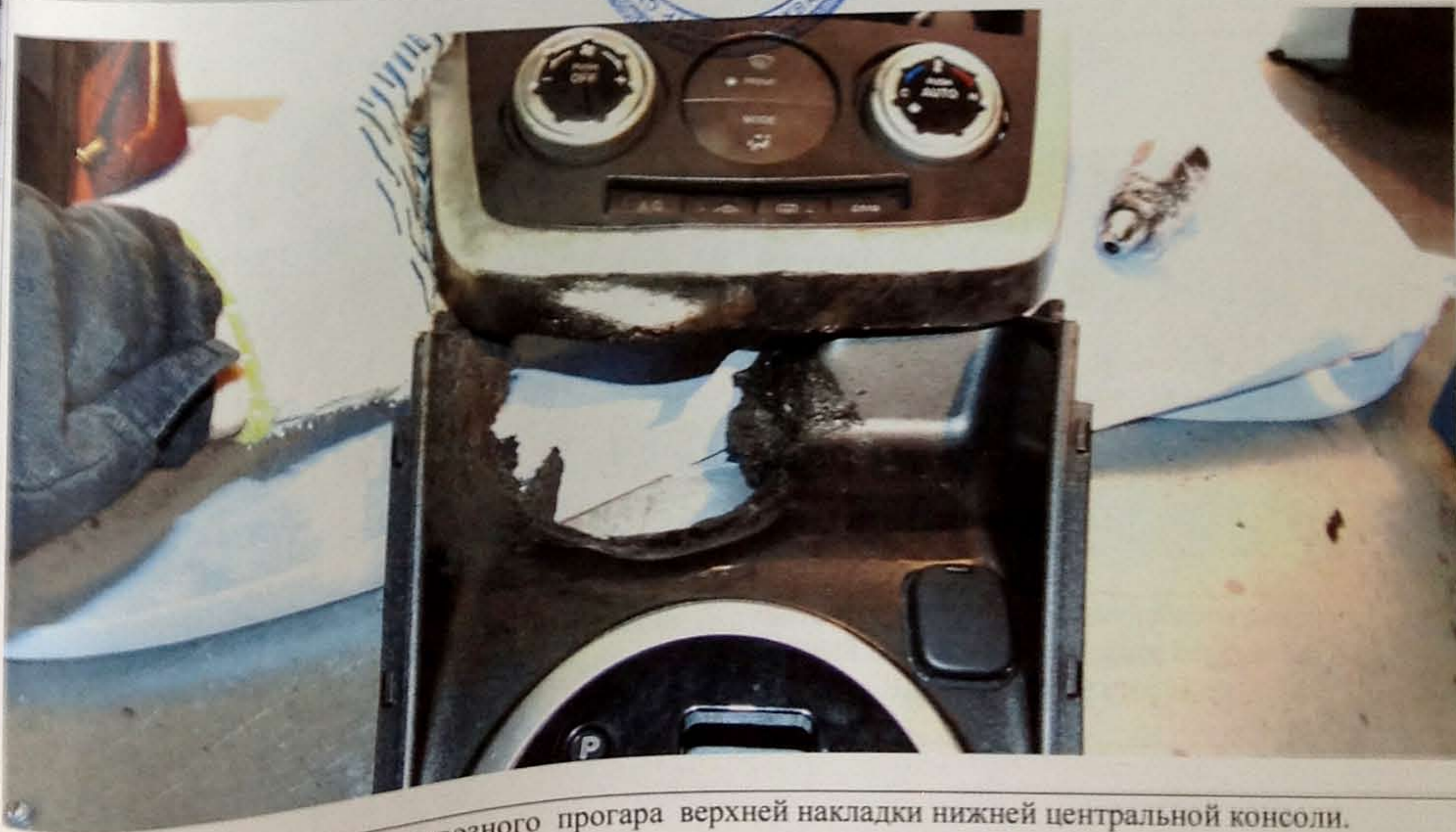
Фото №16. 1- накладка центральной консоли. 2- нижняя часть головного устройства аудиосистемы. 3- обратная сторона блока управления климат-контроля. 4- верхняя накладка нижней центральной консоли. Вид с обратной стороны.
