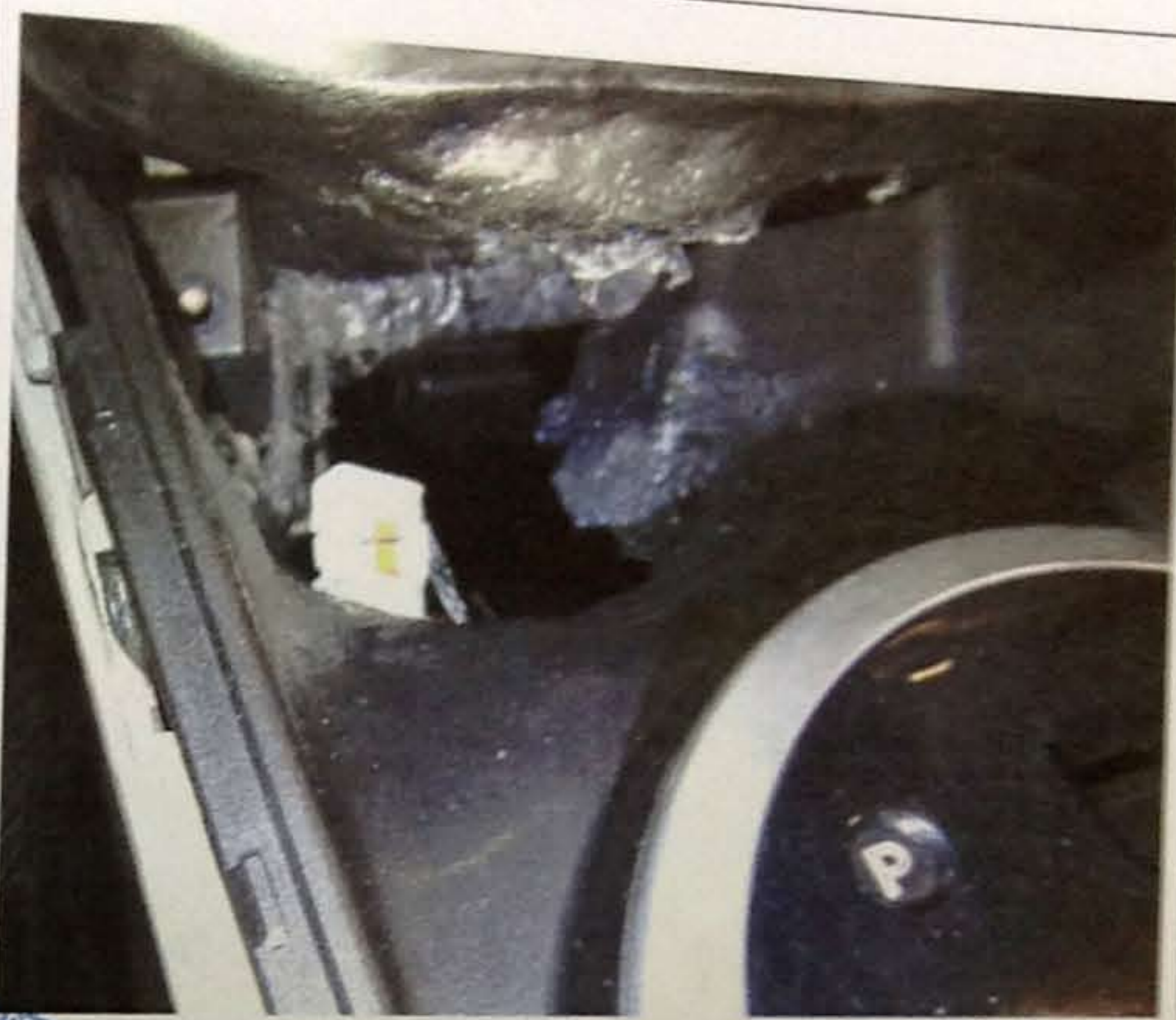
Фото № 10. Сквозной прогар верхней накладке нижней центральной консоли (место для хранения мелких вещей). Вид слева.
