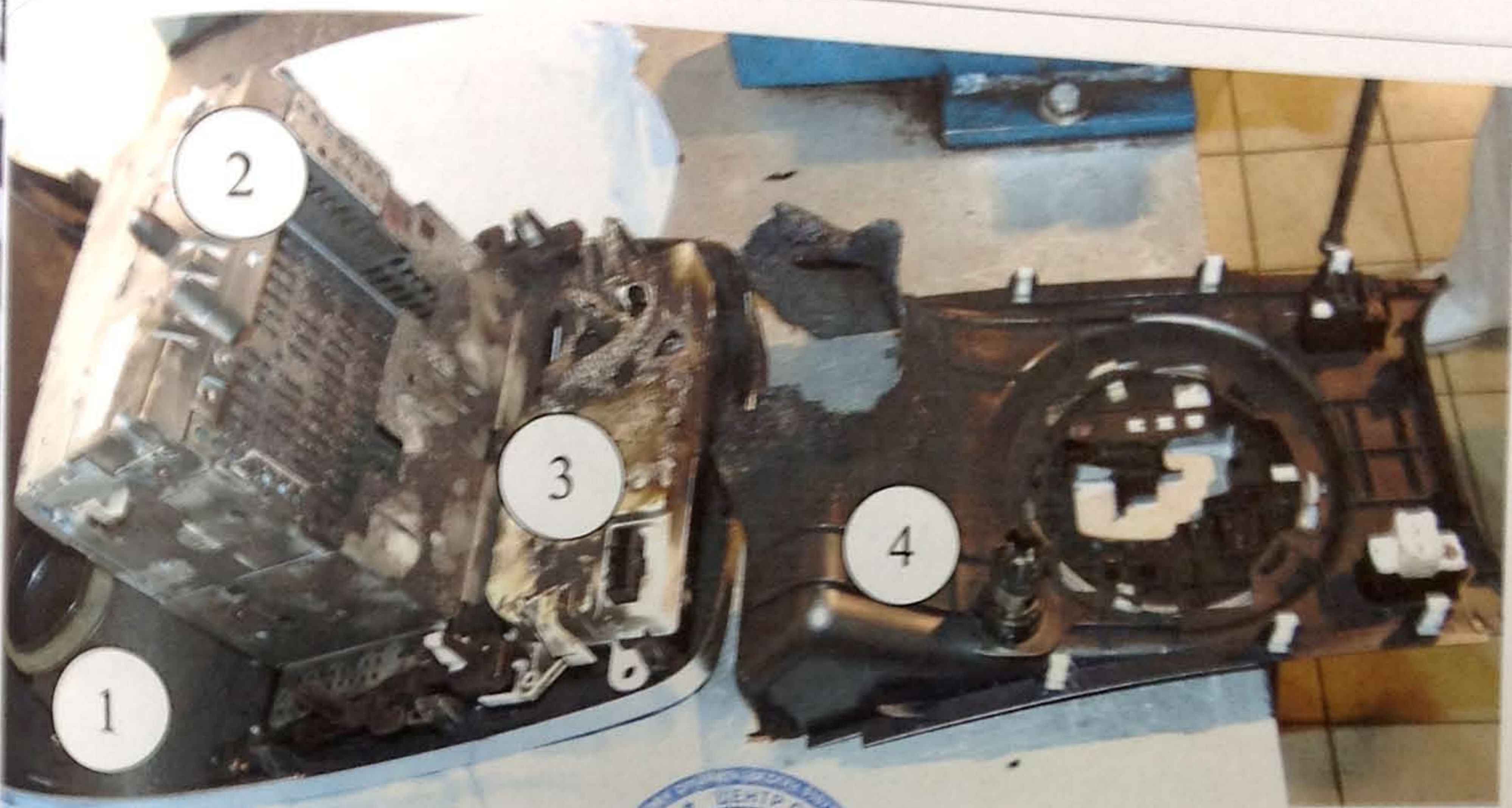
Фото №16. 1- накладка центральной консоли. 2- нижняя часть головного устройства аудиосистемы. 3- обратная сторона блока управления климат-контроля. 4- верхняя накладка нижней центральной консоли. Вид с обратной стороны.
