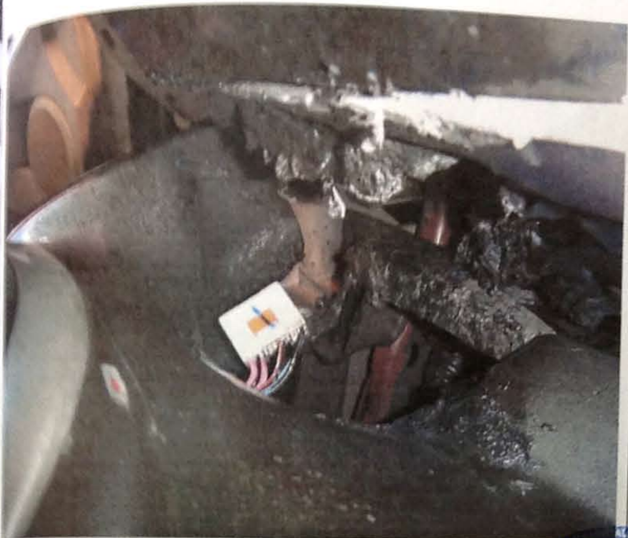
Фото №9. Сквозной прогар верхней накладке нижней центральной консоли. Вид с права.
