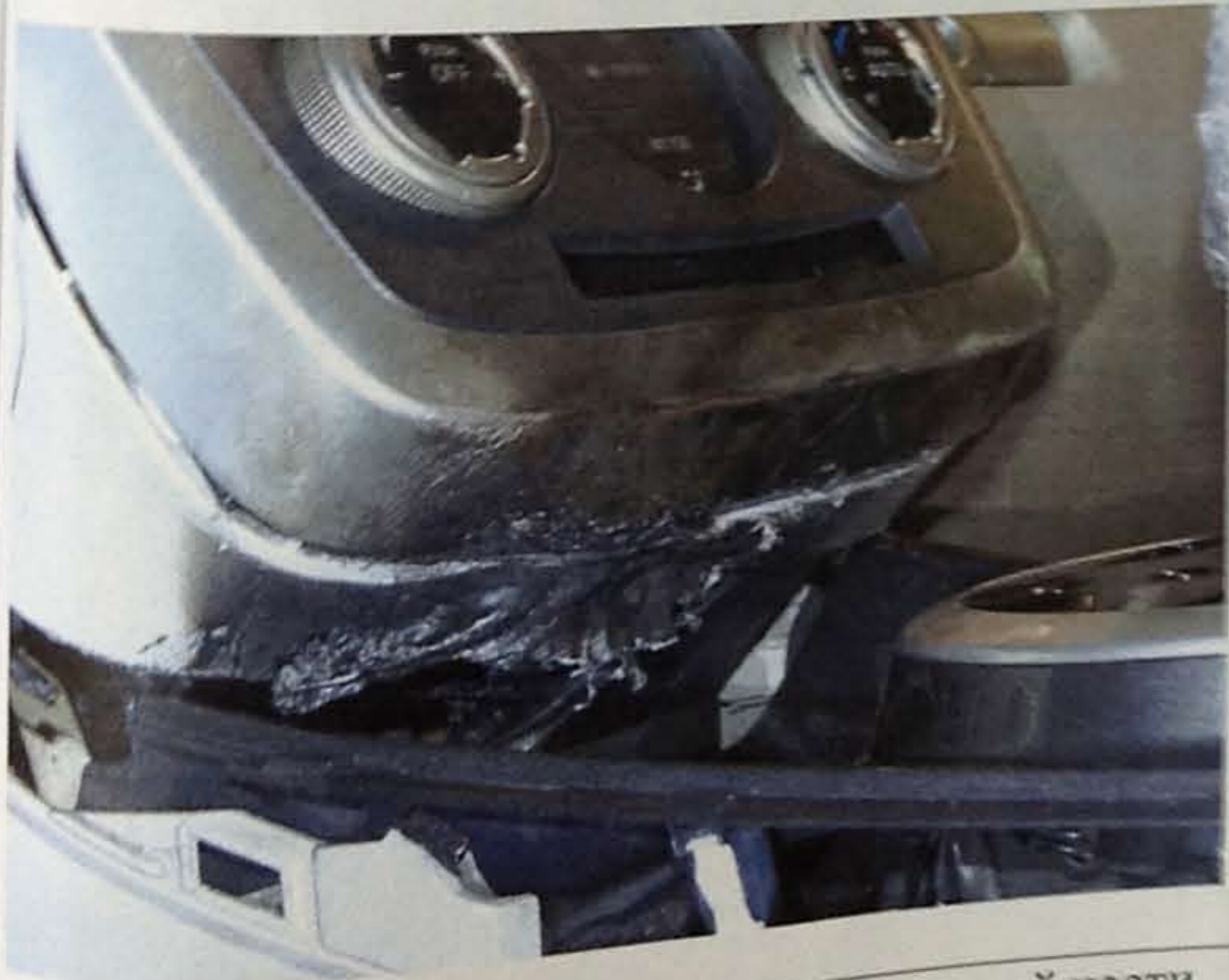
Фото № 7. Вид с лева нижней фронтальной части центральной консоли «торпедо» и накладки центральной консоли со следами переугливания пластика.
